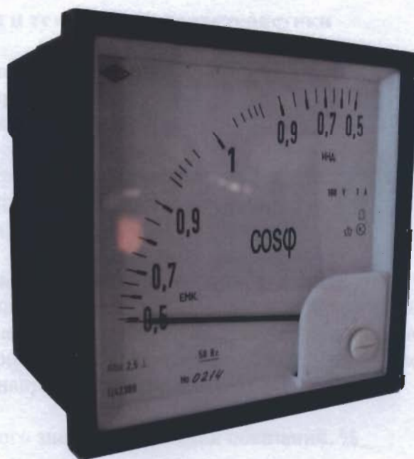
Рисунок 1 – Фотография измерителя коэффициента мощности Ц42309
